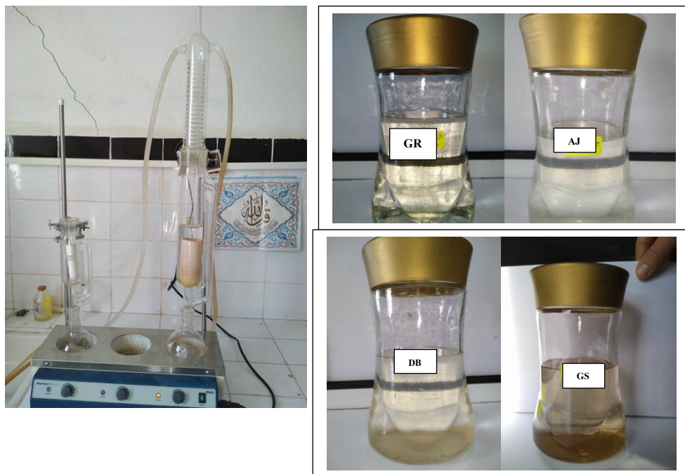
Figure 16 : Extraction de l'huile des noyaux de dattes de quatre variétés par la méthode de Soxhlet. (photo original).
