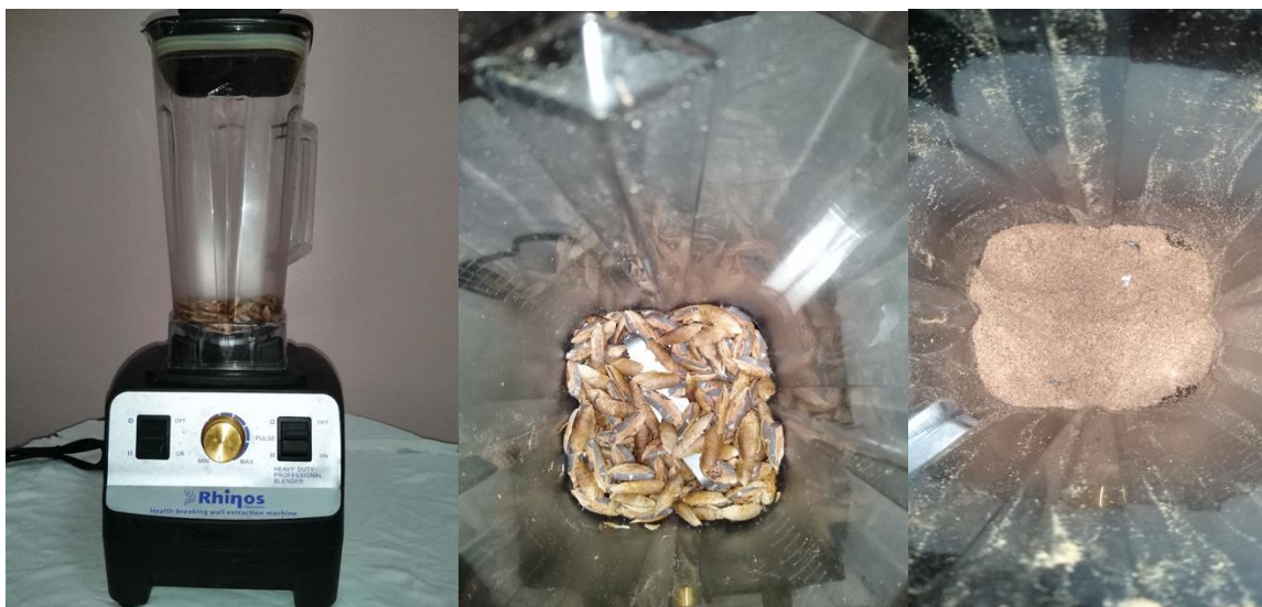
Figure15 : Broyage des noyaux de dattes à l'aide d'un blender. (photo original).
